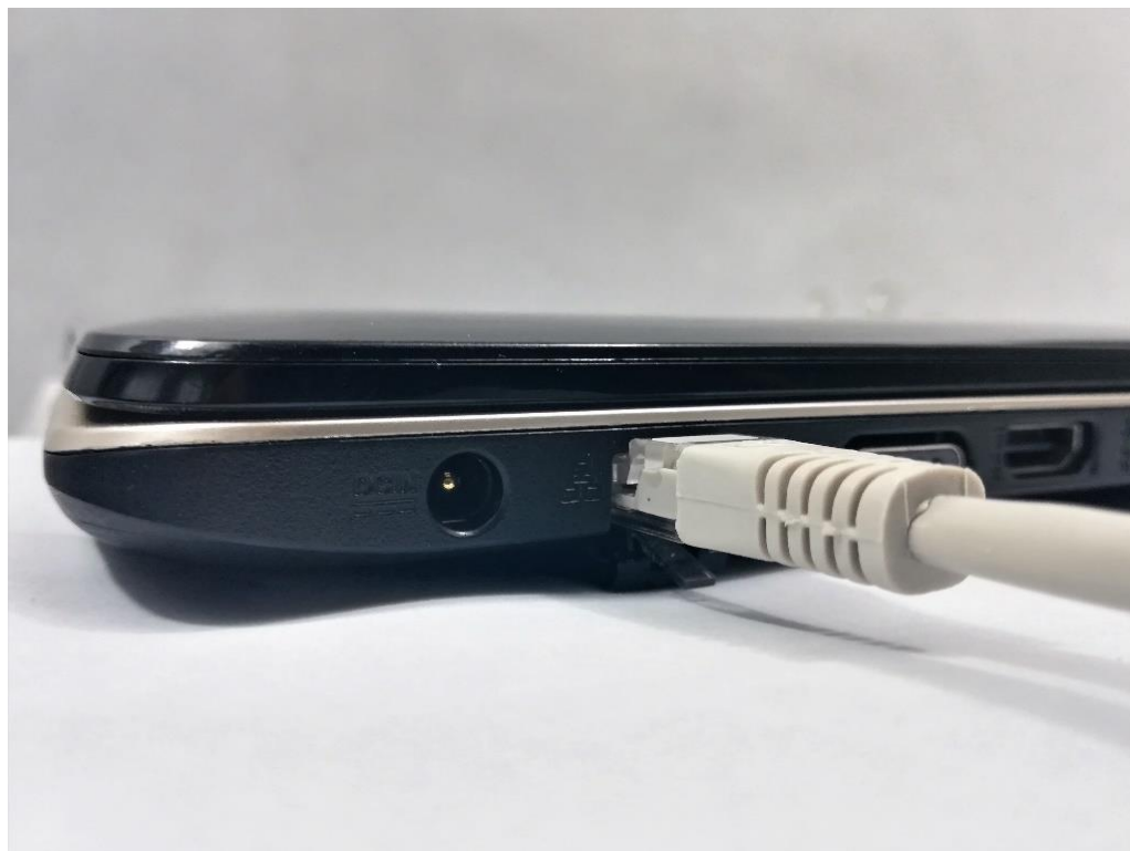
Rysunek 2 Podłączenie kabla sieciowego do komputera
