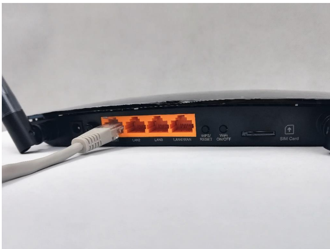
Rysunek 1 Podłączenie kabla sieciowego do routera
